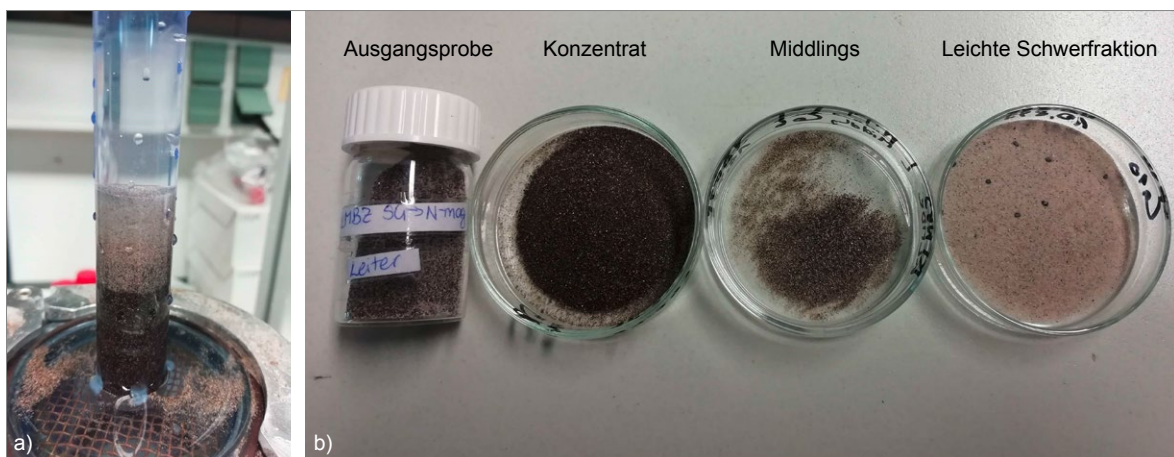
Abb. 10: Tests zur Anreicherung von Kassiterit aus der Probe 35 mit Mikrosetzherd, a) Mikrosetzherd mit Probematerial und Trennungserfolg, b) Gegenüberstellung von Ausgangsprobe, Konzentrat, Mittelgut und leichter Schwerfraktion (GEOS)
