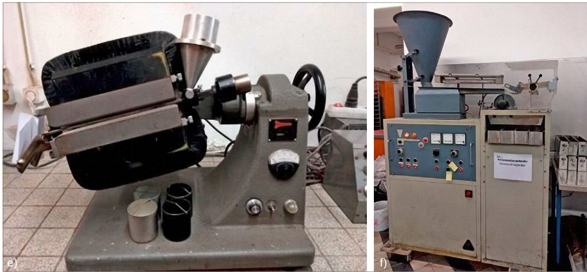
Abb. 8: Probenaufbereitung mittels Frantz-Magnetabscheider (e) und Korona-Walzenseider (f) am Institut für Aufbereitung und Recycling der RWTH Aachen (IAR); (Fotos: PERSCHL 2018)
