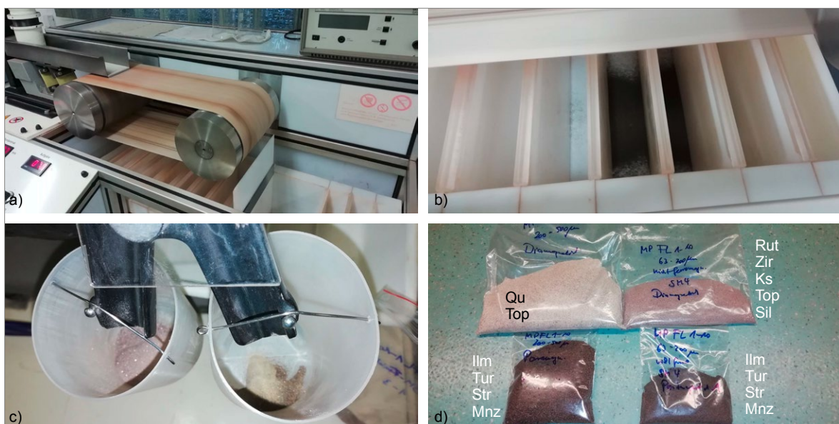
Abb. 11: Anreicherungstests mit der Probe 08/12 auf a/b) Bandmagnetscheider, c) Frantz-Magnetscheider (Labor TU Bergakademie Freiberg), d) Resultate der Bandmagnetscheidung
