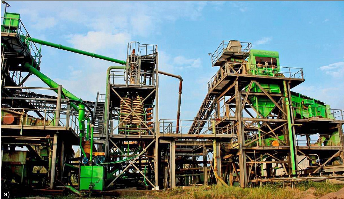
Abb. 3: Aufbau der Probenahme mittels Sortierspirale im Kieswerk 23/24
