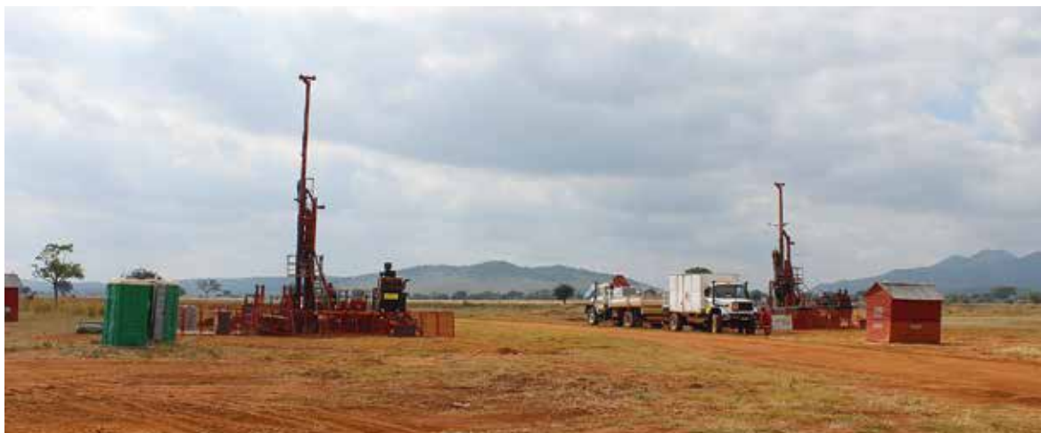
Foto 13: Explorationsbohrungen nach Platinmetallen im Platreef-Projekt von Ivanplats im nördlichen Bushveld (Foto: DERA/H. Marbler 2014)
